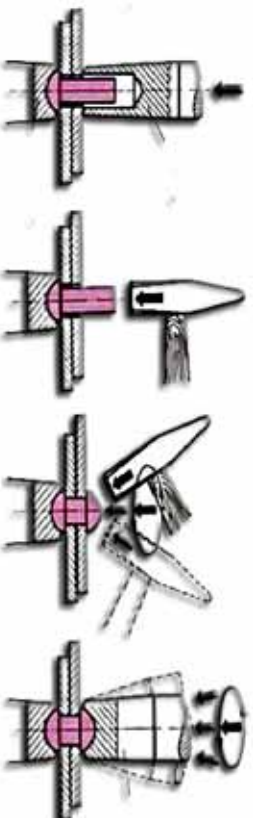
(۳-۱) شکل، د دوه ټوټي فلزاتو د پرچکارۍ مرحلي
