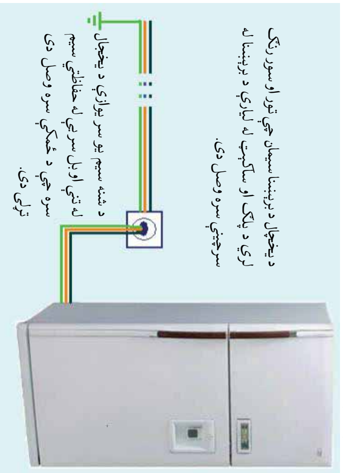
(۲-۳) شکل، د برېښنايي وسایلو په تنه کې د حفاظتي سیم اتصال
