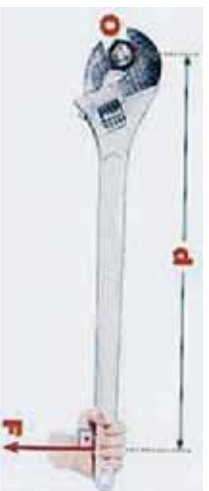
شکل 1-32: مورمټ صفر دی، ځکه چې د قوې د اغیزې کرښه د دوران له ټکي څخه تېرېږي.
