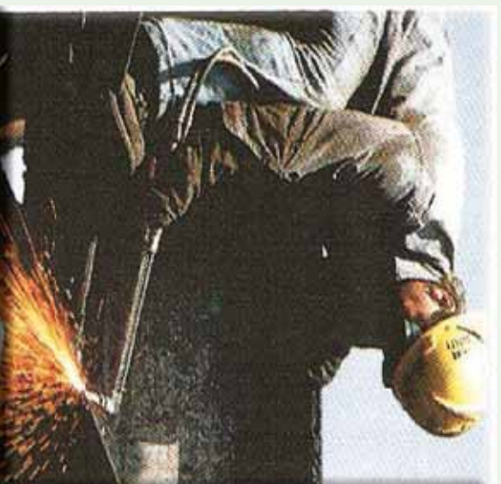
شکل 7-14) اکسی اسیټیلین څراغ د سوځیدلو په وخت کې زیاته تودوخه تولیدوي چې په
