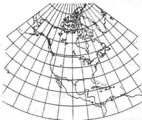
شکل (۵-۱۲) سیستم تصویر نقشه مشابه و مخروطی
