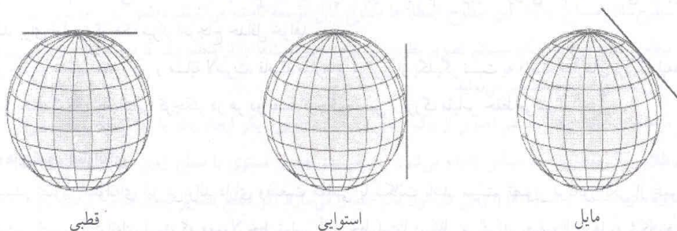
شکل (۵-۸): سیستم تصویر مستوی
