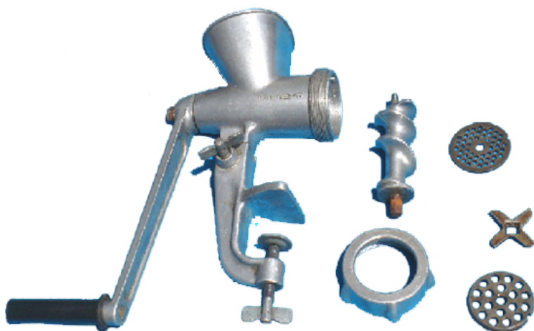
(۱-۴): شکل: د غوښې د ماشین اجزاوې
