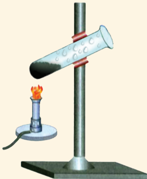
(۳-۱) شکل: دکاربن او هایدروجن د پیژندنې دستگاه
