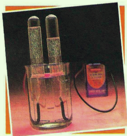
(10-4) شکل د اوبو برېښنايي تجزیه ښيي
