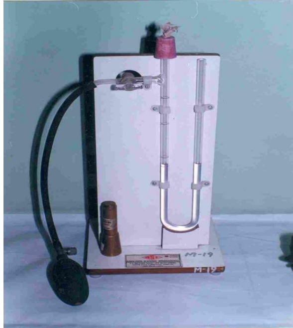
7.2- شکل: د بلین د هوا د نفوذ مننې آلې (Blain's air permeability Apparatus).
