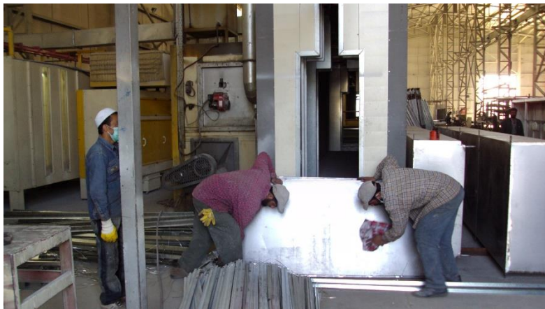
تصویر جریان پاک کاری قبل از رنگ پله های دروازه کانتینر تی آی ام
