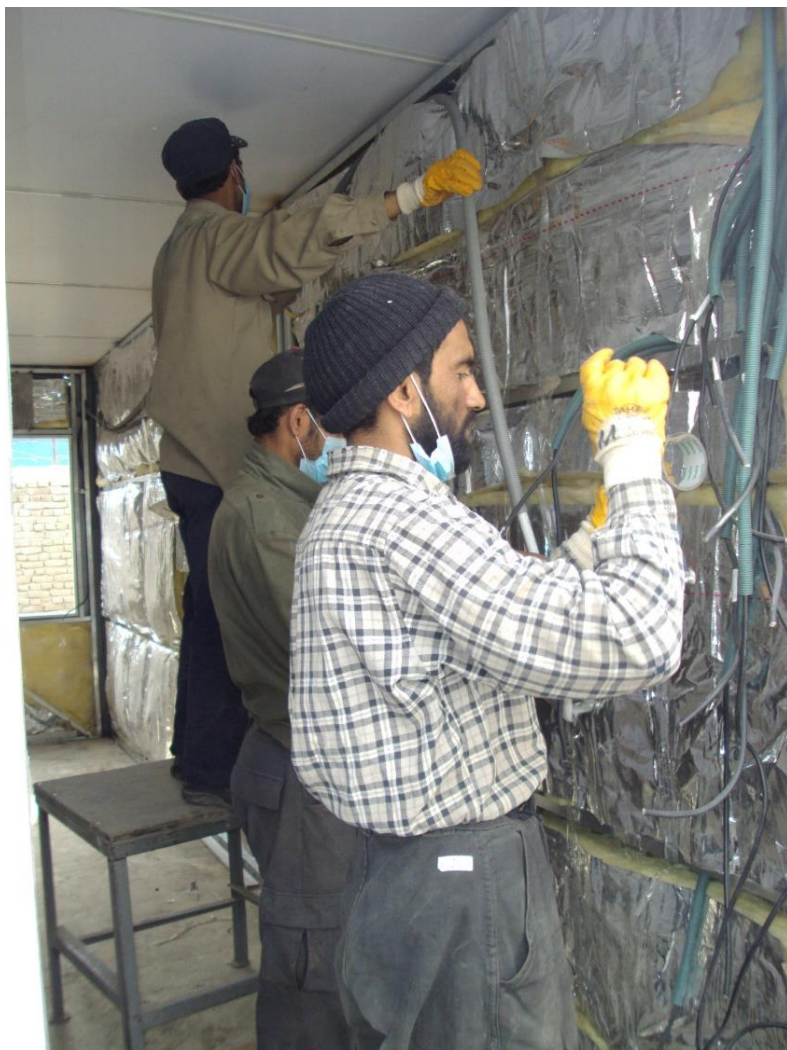
تصویری از جریان عایق کاری کانتینر سازی در فابریکه تی آی ام
