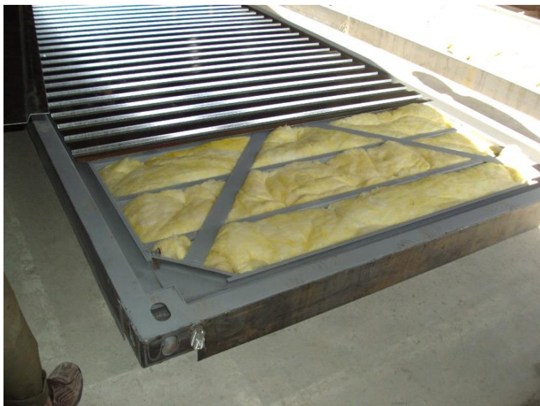
تصویری از جریان عایق کاری بام کانتینر سازی در فابریکه تی آی ام
