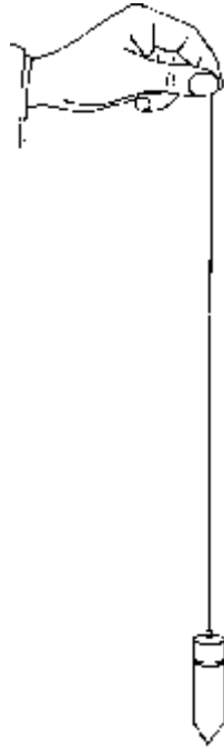
۴ شکل شاقول Fig. 4 A plumb bob
