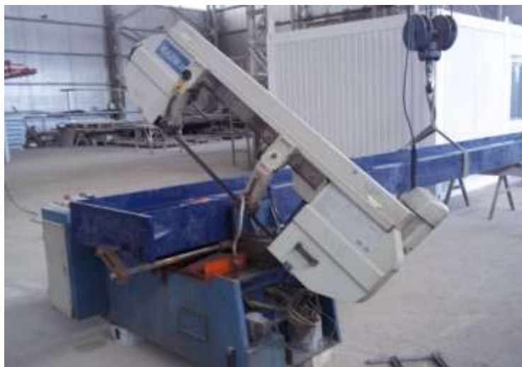
تصویری از برش کاری گادر توسط ماشین مخصوص
