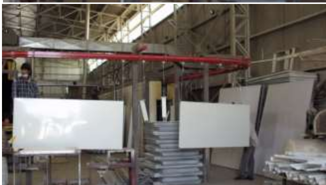
تصاویری ازدروازه های فلزی (پروسس رنگمالی)
