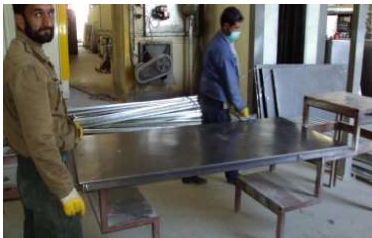
تصویری از پله دروازه های فلزی
