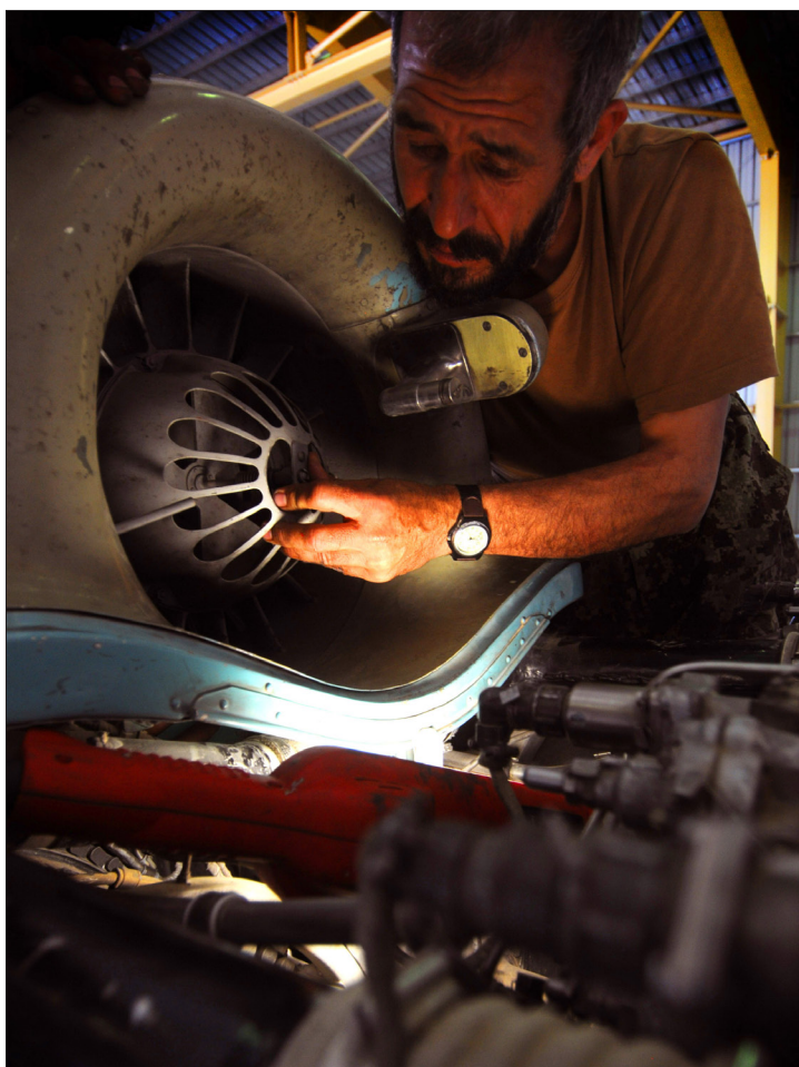
دکندهار د هوای ځواک د هوای مفریزی سرپرست افسر سیفولملوک، د افغان ام، امی ۱۷ ډوله چورلکی څخه د تیلوبادپکی څخه د بدلون پرمهال.
