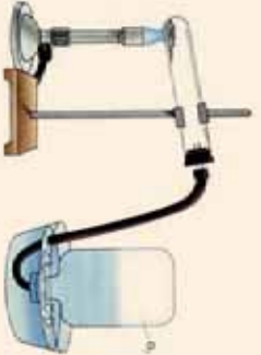
(۱-۱) شکل د اکسیجن لاس ته راوړل له پتاشیم کلوریت څخه
