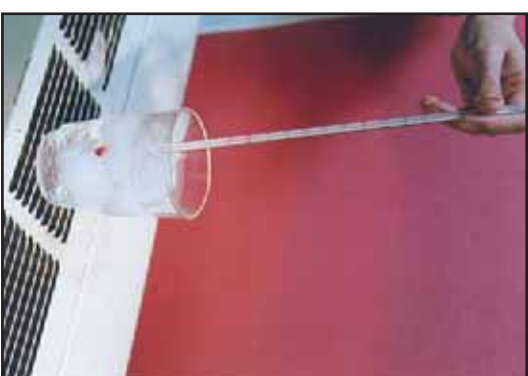
(۲۹-۱) شکل د یخ د ویلي کیدو ټکی اندازه کول
