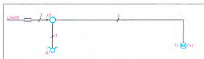
شکل ۳۰ - ۳- شمای فنی مدار کلید دویل
