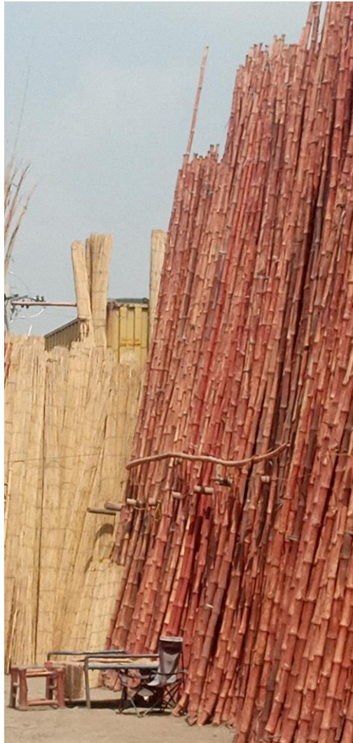
تصویری از بانگس ها ( تنه بانگس ) که برای استفاده به شکل سیخ گول در پخسه پیشنهاد گردیده است
