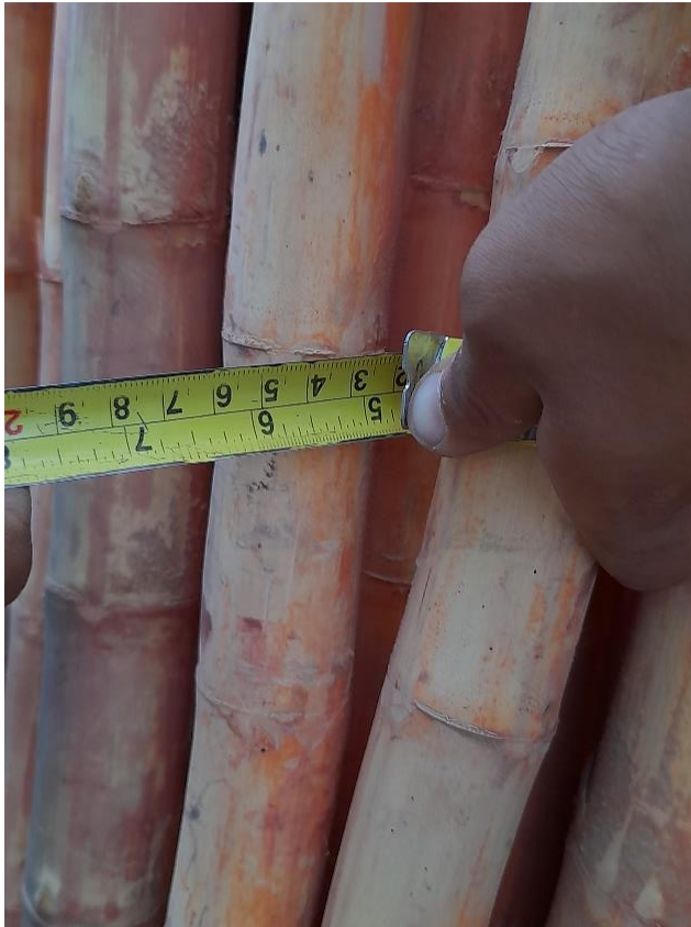
تصویری از بانگس ها برای استفاده در دیوار های پخسه یی (اندازه گیری برای پیدا نمودن محیط)
