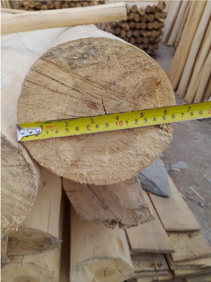
تصویری از اندازه گیری قطر چوب دستک
