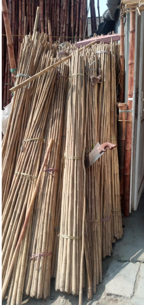
تصویری از بانگس های سر شاخ که برای استفاده به شکل سیخ گول در پخسه پیشنهاد گردیده است
