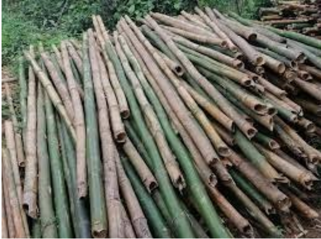
تصویری از بانگس های سر شاخ که برای استفاده به شکل سیخ گول در پخسه پیشنهاد گردیده است
