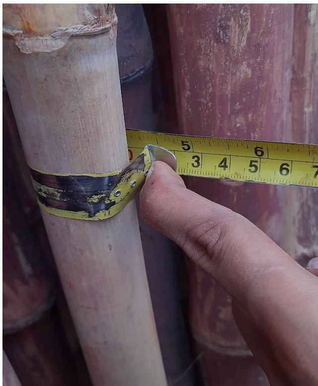
تصویری از بانگس ها برای استفاده در دیوار های پخسه یی (اندازه گیری برای پیدا نمودن محیط)
