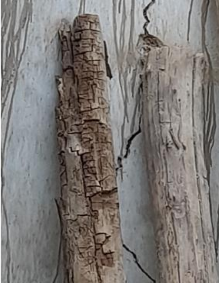
تصویری از چوب دستک دارای پوسیده گی یا کویه خورده گی
