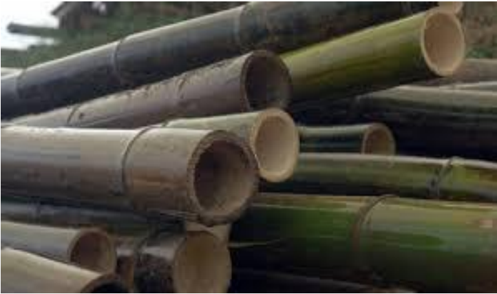
تصویری از نی های میان خالی که برای استفاده به شکل سیخ گول در پخسه پیشنهاد گردیده است
