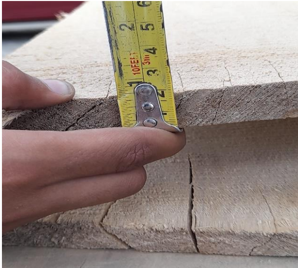
تصویری از اندازه گیری ضخامت تخته برای تخته فرش بام
