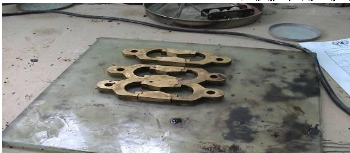
مولدهای مخصوص که در Ductility Test استفاده میگردد
