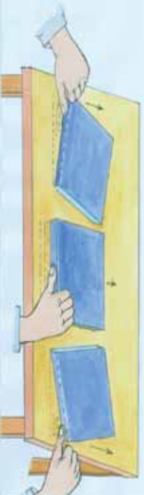
(1-5) شکل، د قوې اثر له هغې نقطې سره چي قوه پرې ورده شوېده، اړیکې لري.
