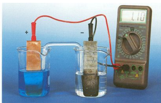
شکل: د دوو محلولونو په منځ کې اړیکې د شبکه لرونکي یو مالګین پل Salt bridge په واسطه
