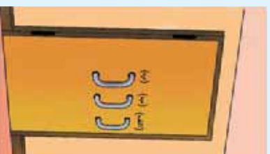
(5-5) شکل، هغه نقطه چې قوه په کې واردېږي، د قوې د مومنت په اندازه کې مهم رول لري
