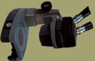
شکل (۶-۱): سټريو مايکروسکوپ
