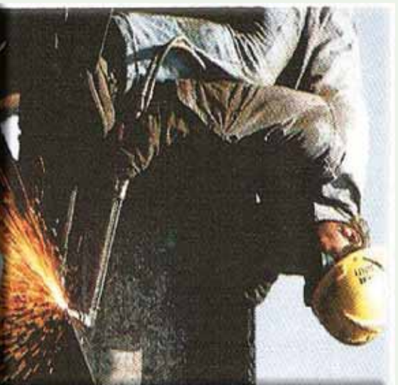
شکل 7-14) اکسی اسیټلین خراغ د سوخیدلو په وخت کې زیاته تودوخه تولیدوي چې په
