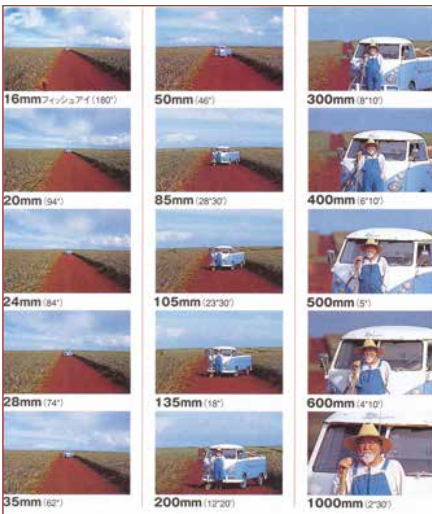
تصویر ۶-۷- تصاویر حاصل از لنزهای مختلف از یک موضوع با زاویه دید هر یک از آن ها
