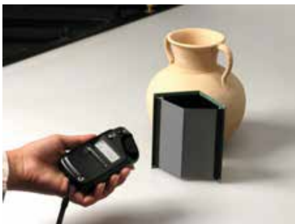
تصویر ۹-۷- نورسنجی بازتابی از کارت خاکستری
