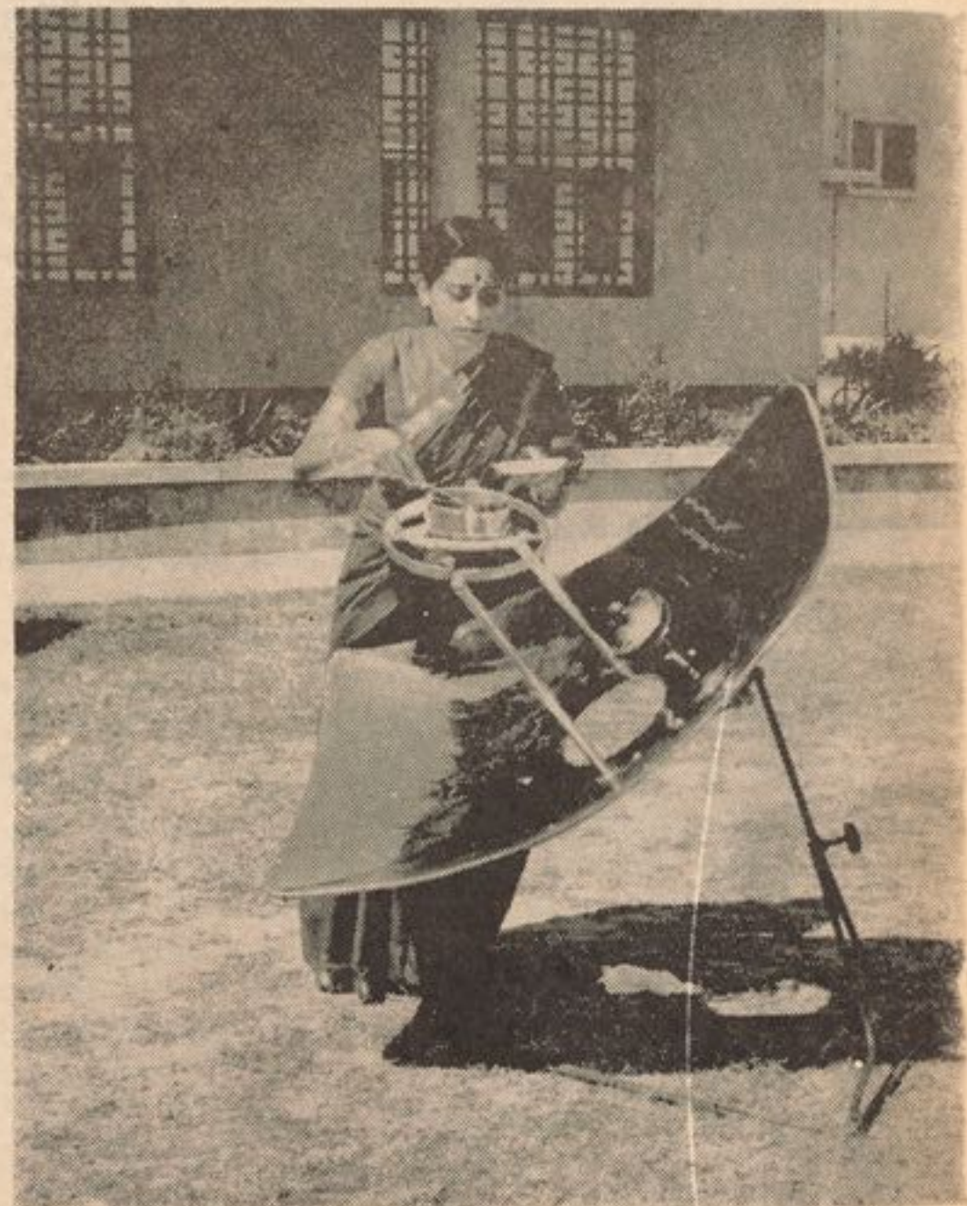
این دستگاه ساده از انعکاس حرارت آفتاب میتواند دیک غذای یک خانواده را پخته کند
