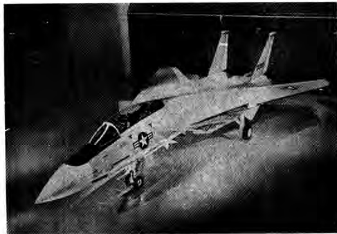
مادل طیاره مافوق سرعت صوت قوای بحری امریکا، از نوع F-14A طیاره مذکور داراى بالهای هندسی میباشد که در اثنای پرواز بمنظور کسب سرعت مافوق صوت جمع می‌گردد و قسمت دم آن نیز دو یونت دارد
