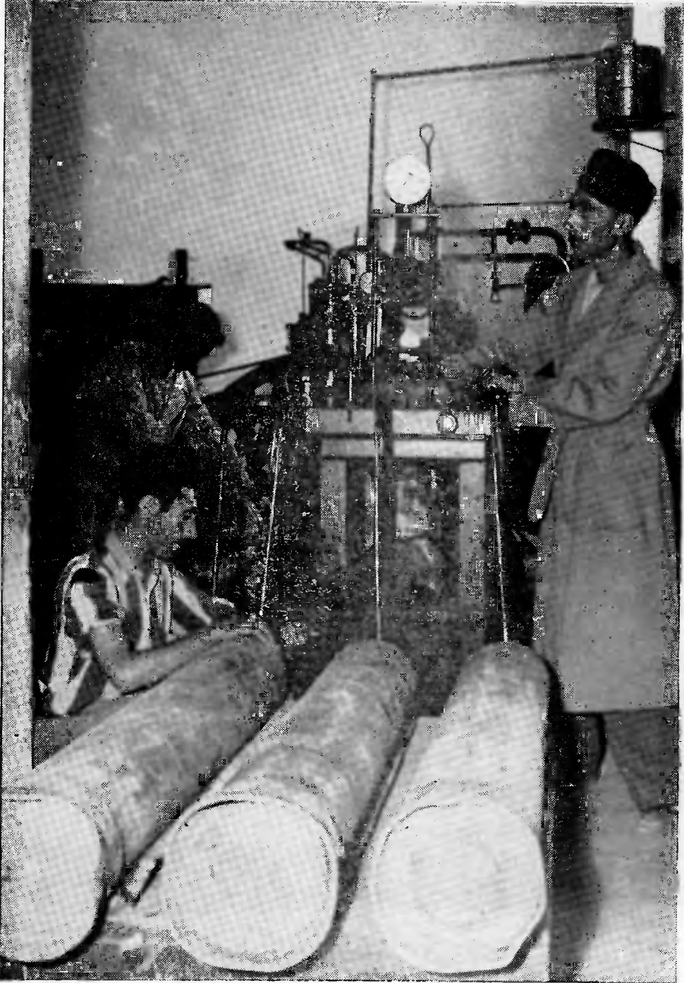
ماشین بر کاری بوتل‌های آکسیجن
