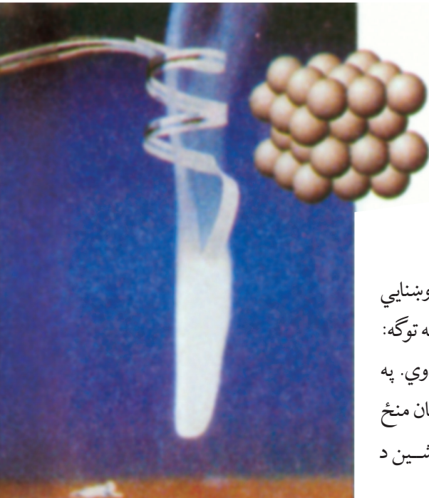
(۴-۳) شکل: د مگنیزیم سوخېدل له روښنایي او تودوخې سره ملگری وي.
