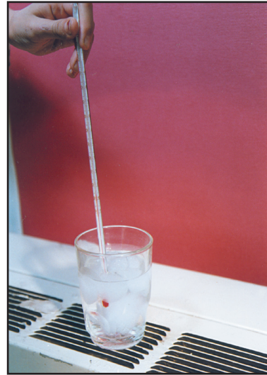
(۱-۲۹) شکل: د یخ دویلي کبډوټکي اندازه کول
