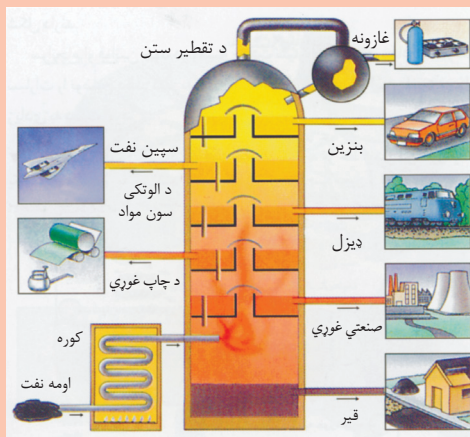
شکل: (۲-۱۱) د نفتو د تصفيې دستگاه
