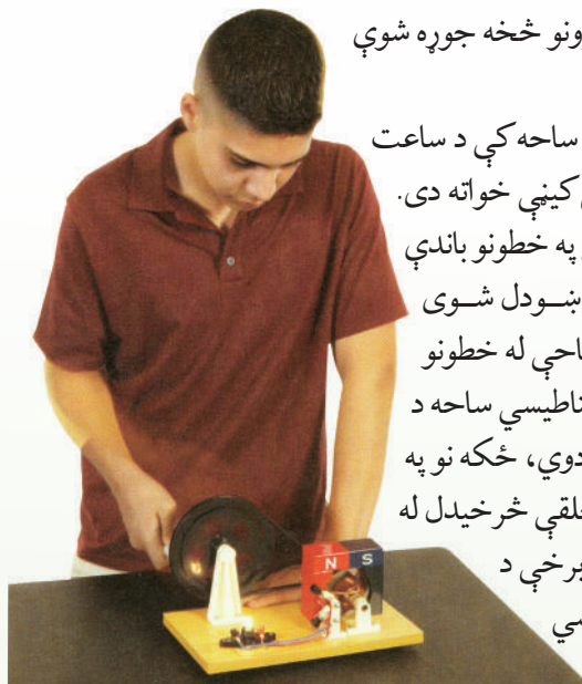
(9-18) شکل: په یو ساده جزاتور کې، په مقناطیسي ساحه کې د هادي حلقو څرخیدل، په حلقو کې د برېښنا متناوب بهیر تولیدوي.
