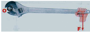
شکل 1-30 د پیچ ټینګول د رنج په وسیله
