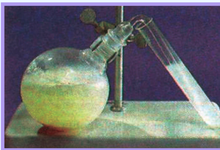
شکل: د گلوگوز د تخمر د ستگاه او د ایتایل الکولو لاسته راوړل (6-8)
