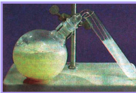
شکل: د گلوگوز د تخمر د ستگاه او د ايتايل الڪولو لاسته راوړل (6-8)
