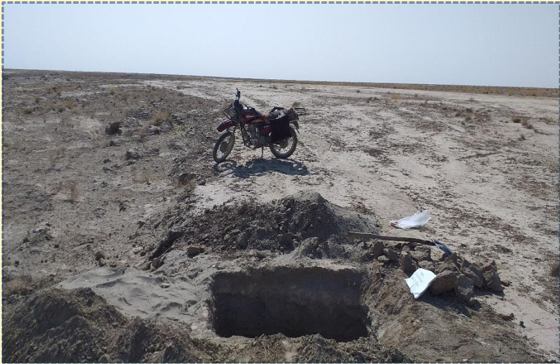
انخور ۱۴۷.۶ د لويي ويالي په اوږدو لوري، خاورې د ازمويني څاه بېلگي بڼه. ليرد را ليرد تپتې يا موټرگاد په مرسته.
