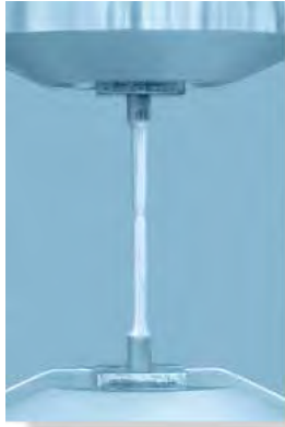
عادي غاړه کیدل یا د غوڅی برخې کمښت چې د فولادو نمونه کې مخکې له ماتیدو ښودل شوي
