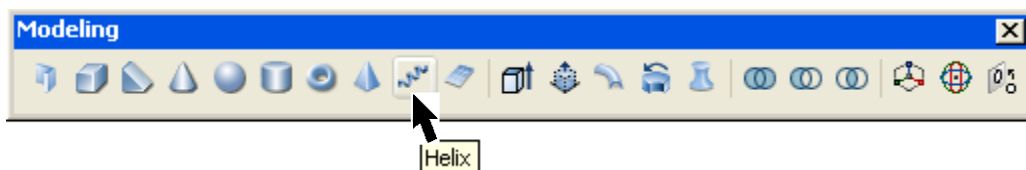
شکل د (Modeling) منيو څخه د پيچلي خط (Helix) د هد ايت غوره کول
