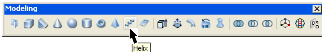
(۴۷-۱) شکل د (Modeling) منیو څخه د پيچلي خط (Helix) د هد ایت غوره کول
