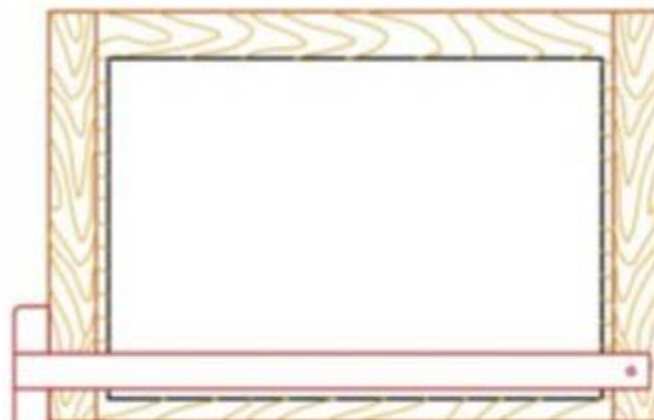
الف) قراردادن خط‌کش تی و کاغذ روی تخته
