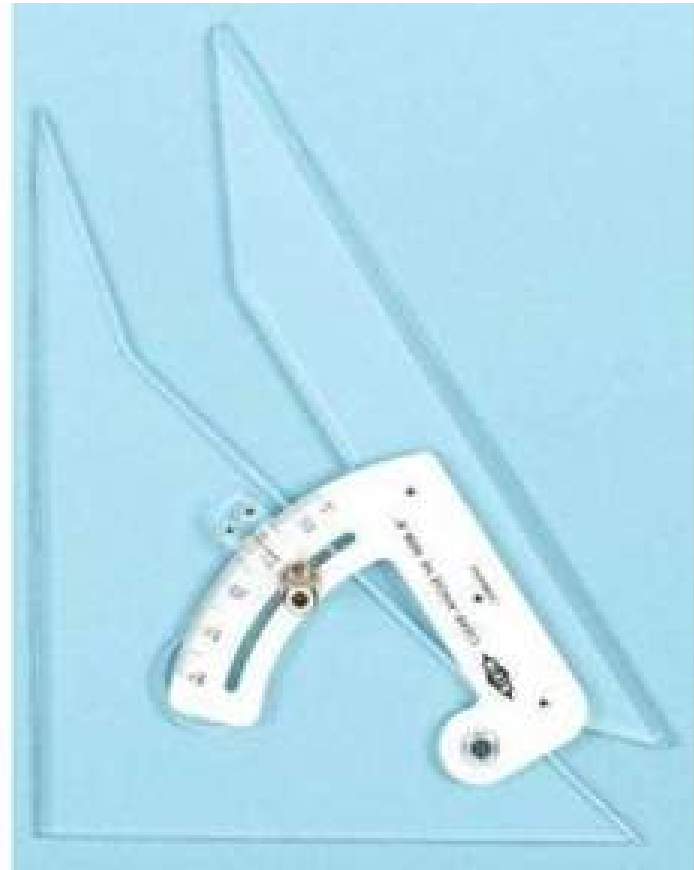
ش (۱۹۱) مثلث دارای یک بخش متحرک و نقاله دار که میتواند برای ترسیم زاویا و اندازه گیری از آن استفاده شود
