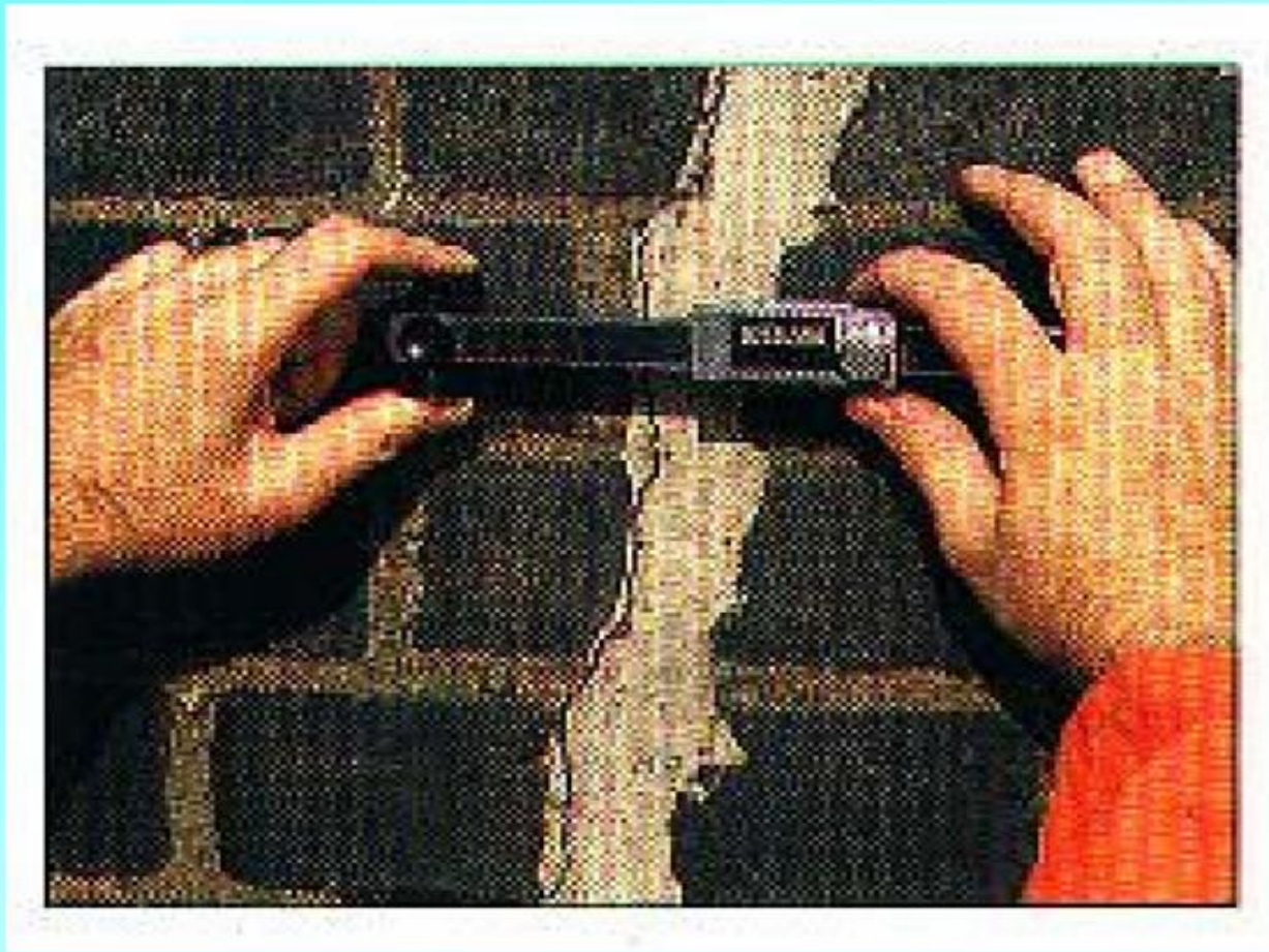
DIGITAL CRACK GAUGE - ELE
