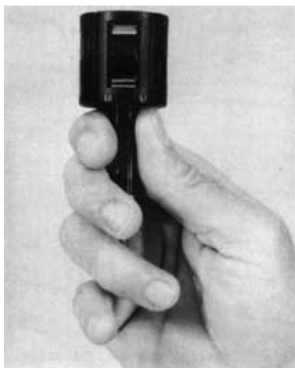
۲۶ شکل ډبل منشوری څلور ضلعي Fig. 26 A double prismatic square
