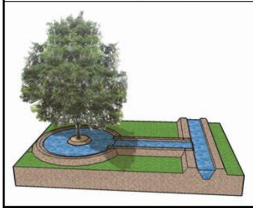
۵۷ شکل: د میوو د ونو لپاره د سطحې د اوبولو سیستم سرچینه: F.Sandor, RoP-Jalalabad, Afghanistan (2008)
