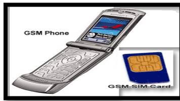
[۲. ۷] شکل، د Mobile Station یوه نمونه.
