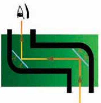
(6-14) شکل، يو ساده پيرسکوپ
