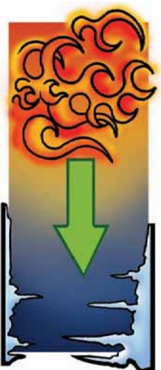
(۳۴-۱) شکل له تاوده جسم څخه ساره جسم ته تودوخه تېرېدنه
