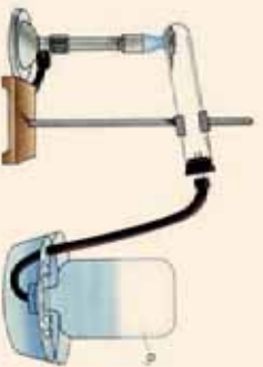
(۱۰-۴) شکل د اکسیجن لاس ته راوړل له پتاشیم کلوریت څخه
