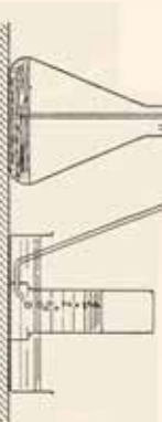
(۱۱-۴) شکل د اکسیجن لاس ته راوړل له هایدروجن پر اکساید څخه
