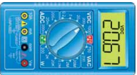
شکل (3-22)، دیجیتالې ملتي متر
