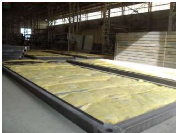
تصویری از عایق کاری حرارتی فرش کانتینر
