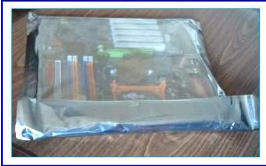
(دمادر بورډ Motherboard لوحه په پلاستیک کې)
